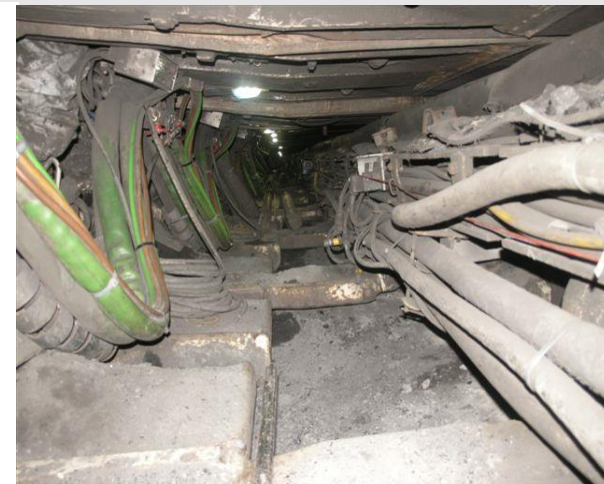
Fot. 1. Ściana strugowa, przejście dla załogi. Zupełny brak kontaktu wzrokowego ze strefą urabiania
